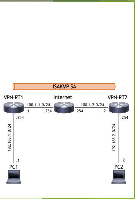
VTI over IPsec では、Tunnel mode を「ipsec ipv4」 とし、ipsec profile を適用する。
