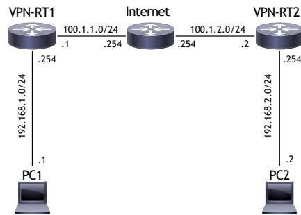
VTI over IPsec の場合、GRE は使用せずに IPsec として IP header を付与する。
