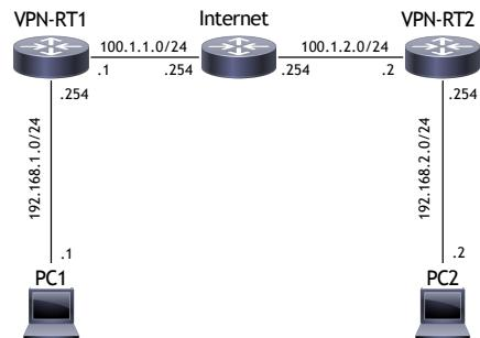
GRE を使用せずに、Tunnel mode を IPsec とすることでも IPsec VPN を構築することが可能となる。
